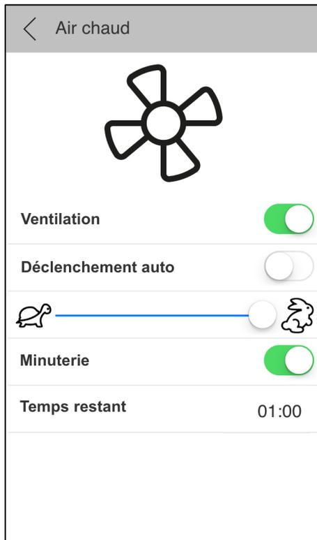
**VENTILATION** : Activation/désactivation du système de ventilation d'air chaud (accumulateur, ou soufflage dans la pièce)
