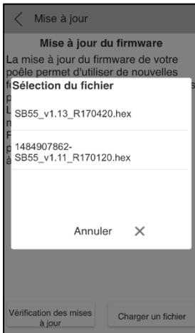
Exemple de liste de micro-logiciel disponible. La mention [backup] signifie qu'il s'agit de la version incluse à l'application. Sélectionner la version à programmer dans votre poêle en cliquant sur la ligne souhaitée.
