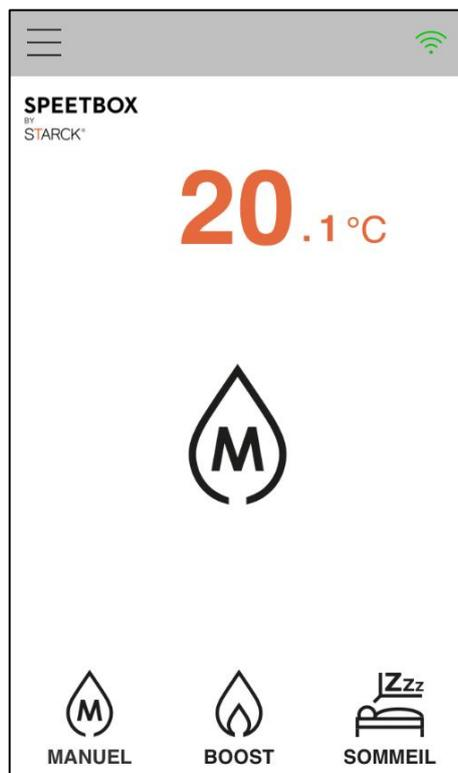
En mode **MANUEL**, il n'est pas possible de passer en mode SEMI-AUTOMATIQUE ou AUTOMATIQUE depuis l'application. L'appui sur le bouton MODE du poêle est nécessaire pour réactiver ces modes.
