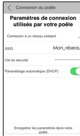
Renseigner la clé de sécurité de votre réseau, activer le paramétrage automatique (recommandé), et Valider en cliquant sur le bouton « **Enregistrer les paramètres dans votre poêle** »
