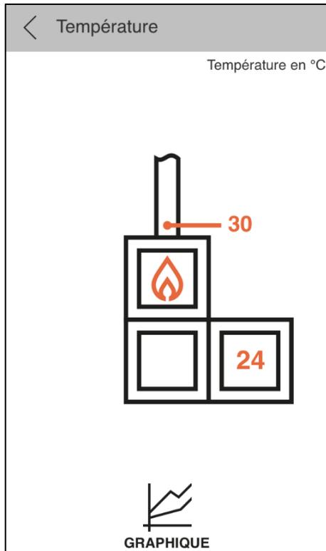
Visualisation de la température des fumées et de blocs accumulateurs
