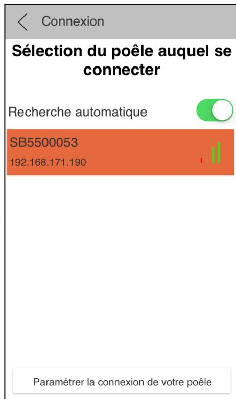
**RECHERCHE AUTOMATIQUE :** Si le mode est activé, l'application liste les poêles présents sur le réseau. Pour communiquer avec l'un d'eux, il suffit de sélectionner la ligne correspondante.
