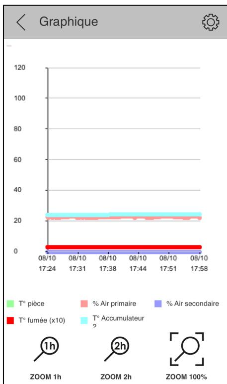
Visualisation de la température des fumées et de blocs accumulateurs
